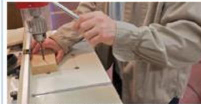
هناك خطورة في ارتداء ملابس فضفاضة. غير مطوية أو أكمام طويلة، غير مزرر عند العمل حول الآلات متحركة.
