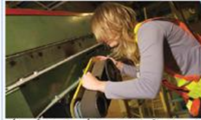
الشعر الطويلة والفضفاض يمكن أن يخلق خطراً. ربط أو تغطية الشعر الطويل لشعر الوجه عند العمل بقرب أجزاء الآلات المتحركة.
